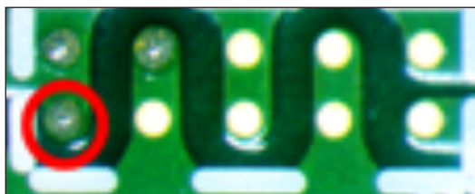
図2: パッドへのはんだの正しい塗布。
